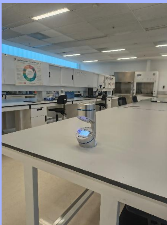
Figuras 2 y 3. Muestreo del aire interior y exterior de un archivo con un biocolelector tipo SAS ubicado a 1.5 m de altura del piso aproximadamente.
