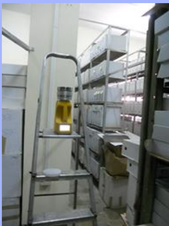
Figuras 2 y 3. Muestreo del aire interior y exterior de un archivo con un biocolelector tipo SAS ubicado a 1.5 m de altura del piso aproximadamente.
