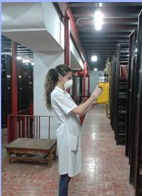
Figuras 2 y 3. Muestreo del aire interior y exterior de un archivo con un biocolelector tipo SAS ubicado a 1.5 m de altura del piso aproximadamente.
