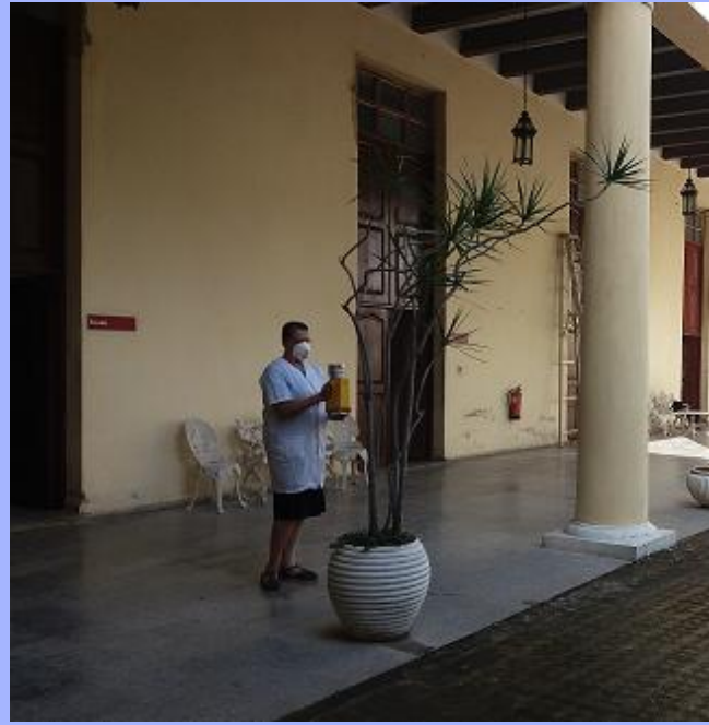
Figuras 2 e 3. Amostragem do ar interior e exterior de um arquivo com um biocoletores do tipo SAS, situado a cerca de 1,5 m de altura em relação ao chão.
