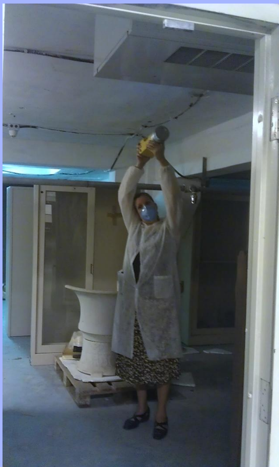
Figura 6. O biocoleto deve ser colocado de frente para a saída de ar que o ar condicionado expelle para o interior do espaço em análise.
