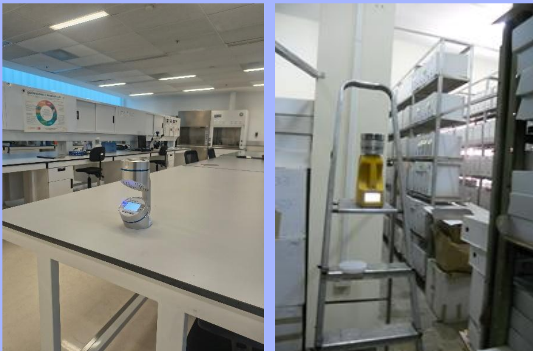
Figura 4 e 5. Amostragem do ar interior de um arquivo com biocoletores do tipo SAS, colocados a cerca de 2 m de altura do chão.
