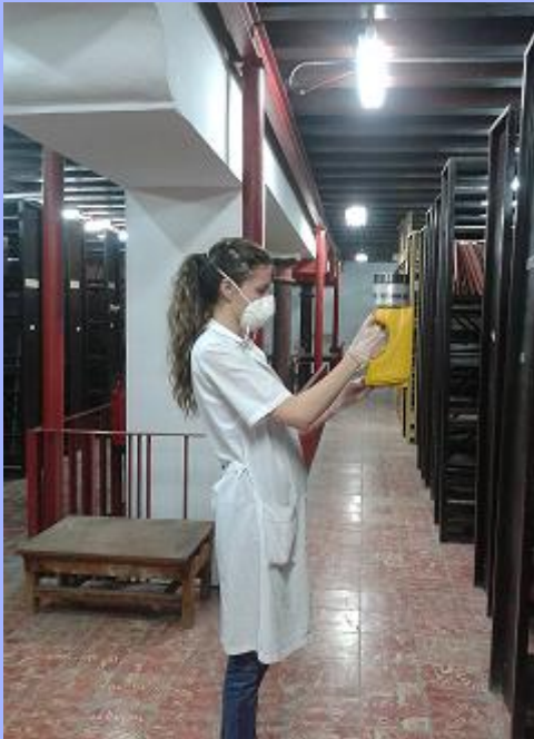
Figuras 2 e 3. Amostragem do ar interior e exterior de um arquivo com um biocoletores do tipo SAS, situado a cerca de 1,5 m de altura em relação ao chão.
